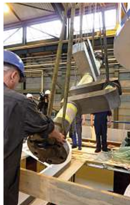
Die neue Kurbelwelle wird eingebaut: Via Kran und Oberdeck...
